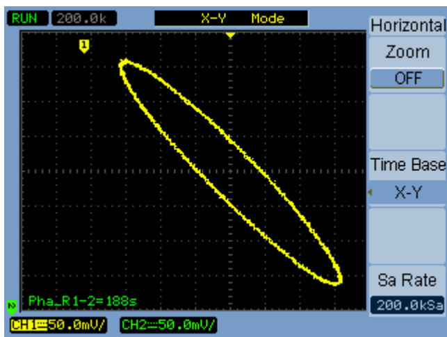
図15 位相のずれた波形を示すX-Y表示フォーマット
